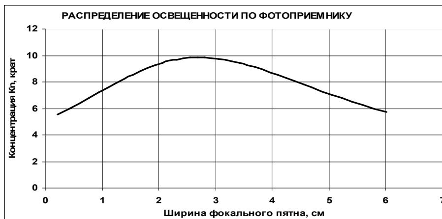
Рис. 4. Распределение концентрации излучения на поверхности линейчатого фотоприемника в зависимости от ширины фокальной области (от 0 до d )
