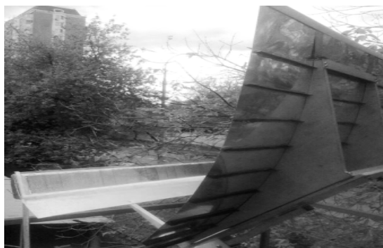
Рис. 6. Солнечный модуль с асимметричным параболоцилиндрическим концентратором, линейчатый фотоприёмник и системой водяного охлаждения Fig. 6. PV module with asymmetric parabolic-cylindric concentrator, linear photoreceiver and water cooling system
