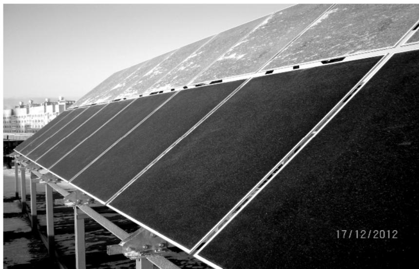
Рис. 1. Пример эксперимента по исследованию влияния осадков в виде изморози на выработку электроэнергии
