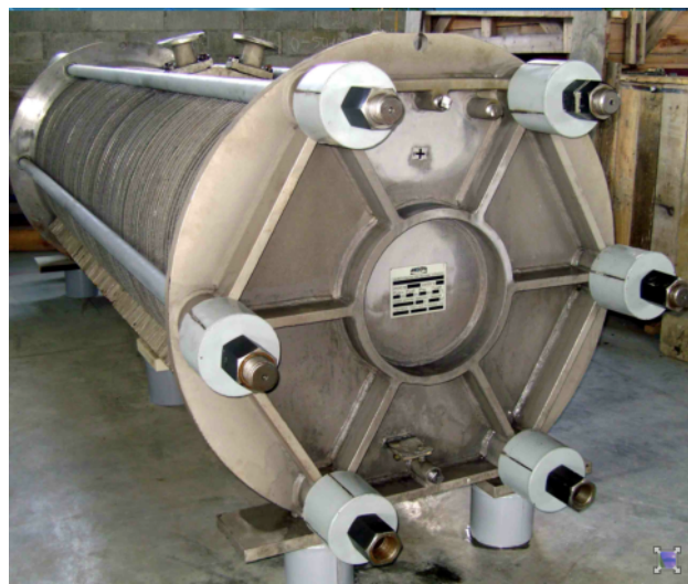
Рис. 4. Электролизер СЭУ-40М производства ООО «Химэнерго» (Свердловская область)
