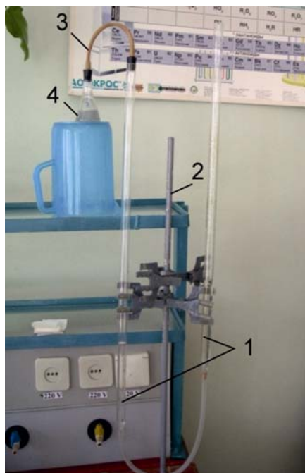
Рис. 1. Прибор для определения молярной массы эквивалента металла
