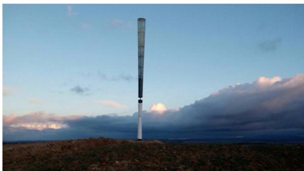
Компания-стартап из Испании создала проект под названием Vortex Bladeless. Разработанные ветротурбины не имеют лопастей и получают электроэнергию от колебаний.
