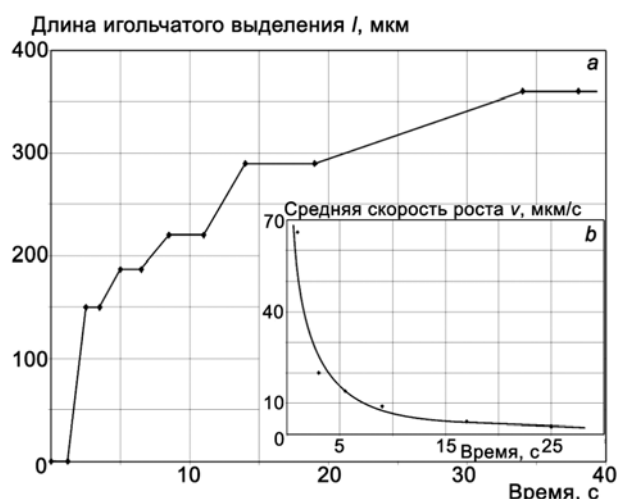
Рис. 2. Кинетические особенности роста игольчатого \beta -выделения: а – изменение длины игольчатого \beta -отростка; б – изменение средней скорости роста \beta -выделения во времени [12]
