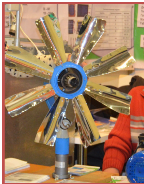
Рис. 5. Ветроприемное устройство с ускорителем ветрового потока: а) компьютерная модель; б) физическая модель Fig. 5. The wind installation with wind flow accelerator: (a) computer model; b) physical model
