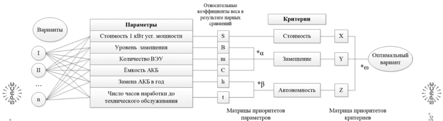
Рис. 4. Алгоритм выбора окончательного варианта состава оборудования ВДЭС с высокой долей замещения Fig. 4. The algorithm of the final version selection of WDP equipment configuration with a high penetration level
