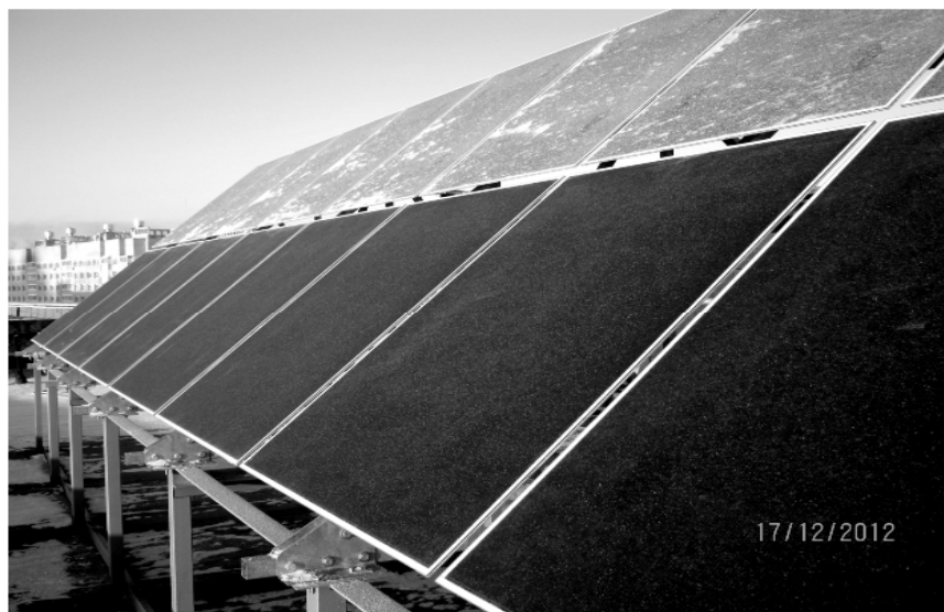
Рис. 1. Пример эксперимента по исследованию влияния осадков в виде изморози на выработку электроэнергии Fig. 1. The example of experiment on the influence of precipitation in the form of frost on the electricity generation
