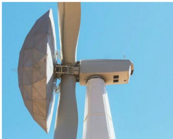
18-метровая алюминиевая куполообразная насадка весом 900 килограмм мешает ветру проходить через лопасти в центре и направляет поток на удаленные от оси вращения части лопастей, оптимизируя тем самым работу турбины.
