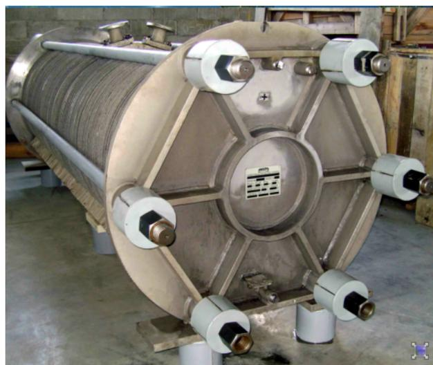
Рис. 4. Электролизер СЭУ-40М производства ООО «Химэнерго» (Свердловская область)
