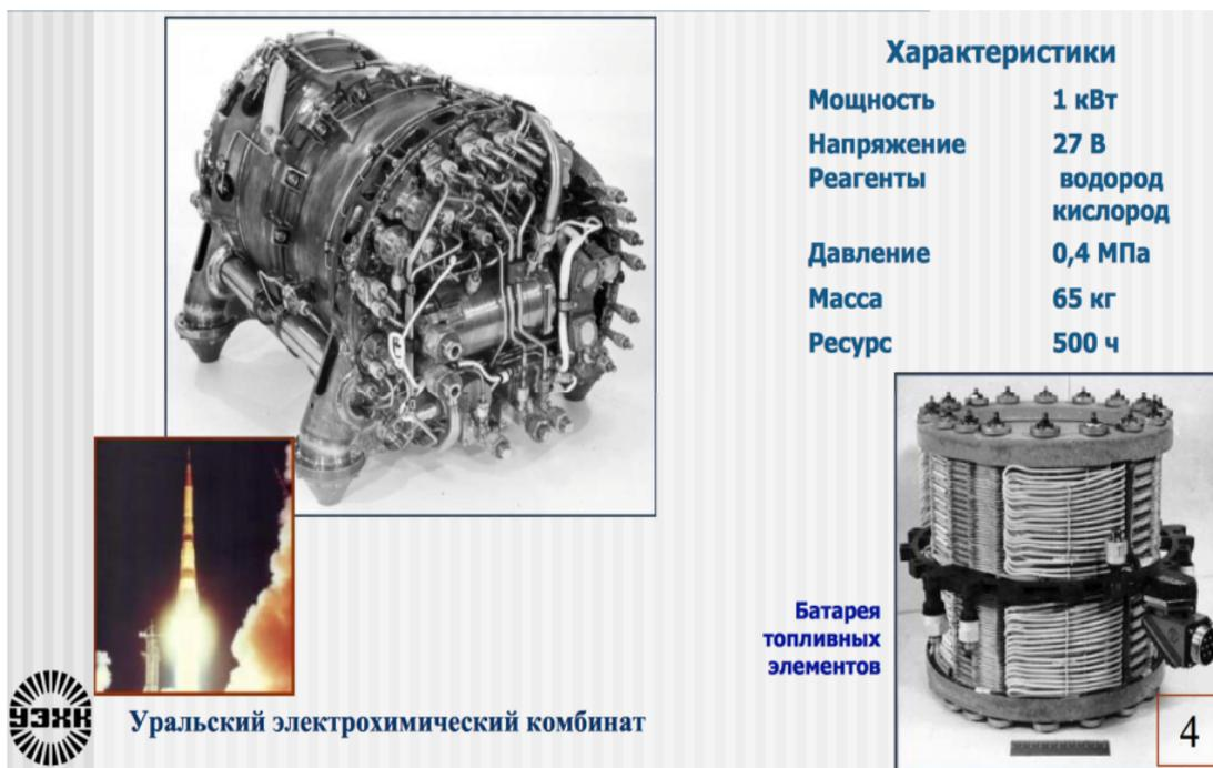
Рис. 2. Водородно-кислородный электрохимический генератор на топливных элементах «ВОЛНА-20»
