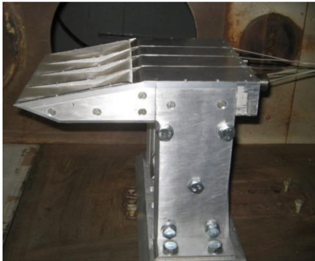
Рис. 11. Собранная модель в рабочей части аэродинамической трубы
