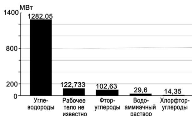
Рис. 2. Сведения о суммарной установленной мощности бинарных электростанций и используемых на них рабочих телах Fig. 2. Information about the total installed capacity of binary power plants and their working fluids
