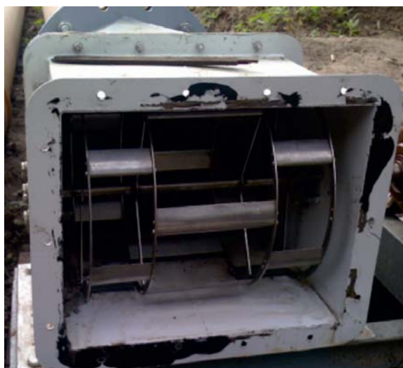
Рис. 8. Ортогональные турбины в напорном потоке Fig. 8. Orthogonal turbine in the pressure stream
