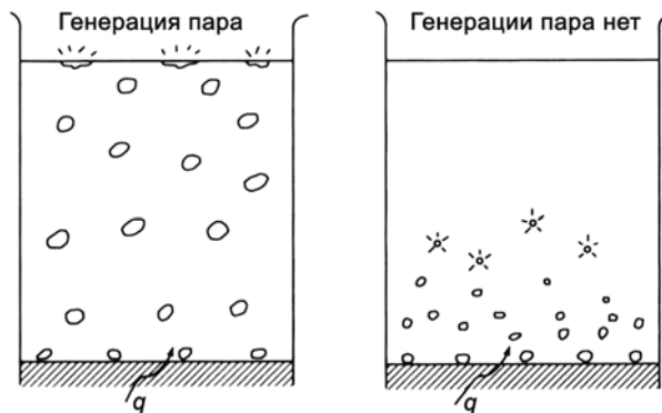
Рис. 5. Кипение в большом объеме: а – кипение насыщенной жидкости; б – кипение недогретой жидкости Fig. 5. Boiling in a large volume: а – boiling of saturated liquid; б – boiling of subcooled liquid
