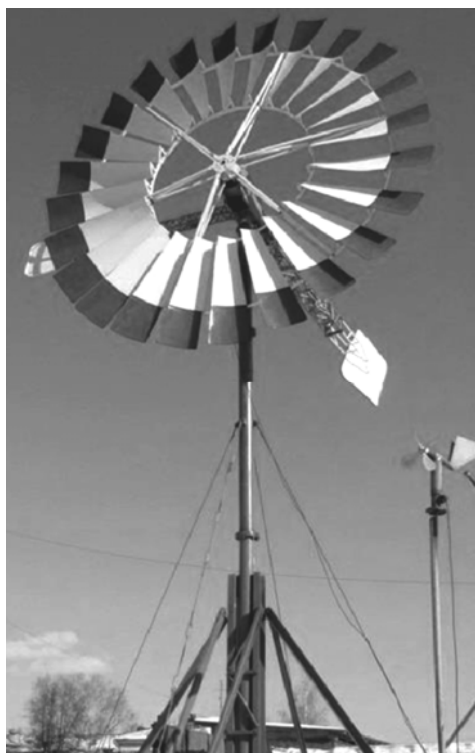
Рис. 1. Внешний вид и принципиальная схема ветроустановки ВЭУ-5-4: 1 – киль; 2 – платформа поворотная; 3 – ветроколесо; 4 – лопасти; 5 – балка боковая со щитом; 6 – опорный узел; 7 – башня; 8 – шарнир; 9 – основание; 10 – лебедка; 11 – растяжка; 12 – фундамент; 13 – механизм останова; 14 – шарнир; 15 – привод; 16 – электрооборудование (кроме установленного в поворотной платформе)
