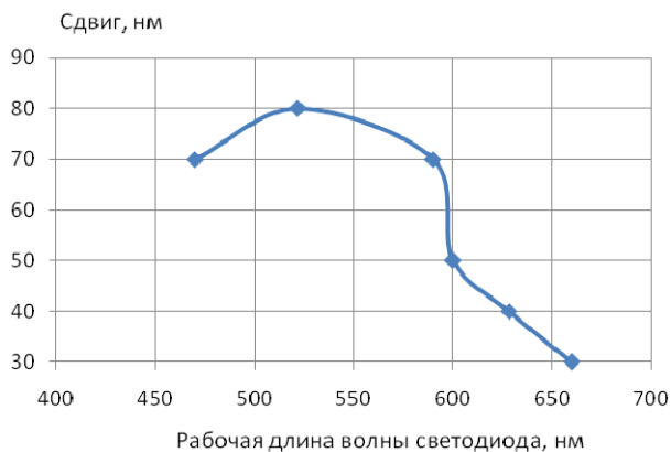
Рис. 2. Сдвиг диапазона максимальной фоточувствительности относительно рабочей длины волны светодиодов
