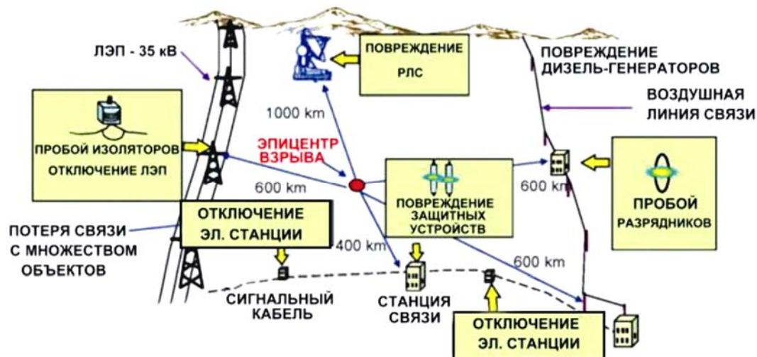
Рис. 1. Иллюстрация повреждений оборудования, подвергнувшегося воздействию высотного ЭМИ ЯВ над Казахстаном в 1962 г. Впервые рисунок был представлен на англ. языке начальником ЦНИИ-12 генерал-майором, д-ром техн. наук, профессором В.М. Лоборевым на международной конференции EUROEM во Франции в 1994 г. [3] Fig. 1. Illustration of equipment damages caused by high-altitude HEMP impact above Kazakhstan in 1962. For the first time the picture was presented in English during the EUROEM conference by the Head of Central R&D Institute-12, Major General, Prof. Dr. Mr. V.M. Loborev in France in 1994 [3]
