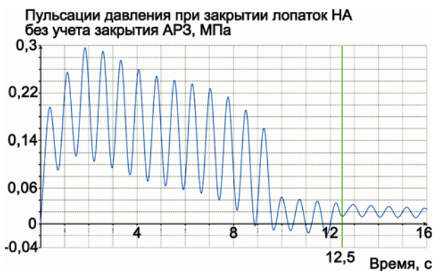
Рис. 4. График пульсаций давления у НА ( t_s=12,5 с; Q = 280 м 3 /с) Fig. 4. Diagram of pressure pulsations of guide vane ( t_s=12,5 с; Q = 280 м 3 /с)
