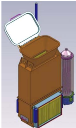
Рис. 2. Газогенератор с рабочей камерой прямоугольного сечения Fig. 2. The gas generator to the working chamber of rectangular cross section
