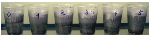
Рис. 1. Емкости с суспензией алюминий + агар-агар + вода Fig. 1. Containers with a suspension of aluminum + agar-agar + water
