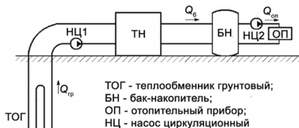
Рис. 3. Схема теплонасосной установки Fig. 3. Scheme of the heat pump system
