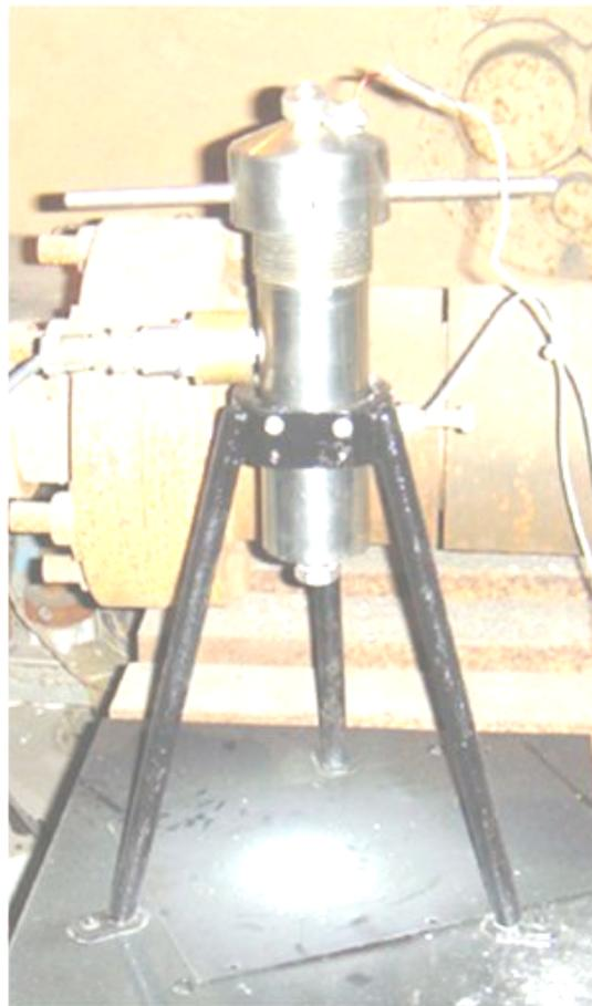
**Рис. 8.** Лабораторный реактор-генератор для получения пароводородной смеси при сжигании мелкодисперсного алюминия в гелеобразной воде
