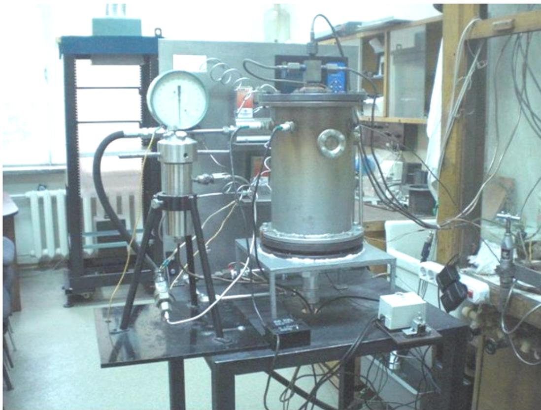
Рис. 11. Стенд с установленными реактором-генератором пароводородной смеси и матричным горелочным устройством для сжигания биогаза и пароводородной смеси
