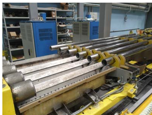
Автоматизированная установка УТС-1 "Трубметпрома" для удаления технологической смазки с наружной и внутренней поверхности труб Ø 15÷50 мм (фото "Трубметпром")
